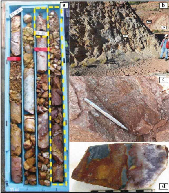
Şekil 4. a) KED 135-03 karot numunesi (35,50 m.), b) Kestanelik granitoidinin killeşme (kil), silisleşme (si) ve demiroksit (dem) alterasyonunun sahadaki görünümü, c) Yoğun altere mostra örneği d) Killeşme-silisleşme içeren breşik yapılı el örneği (Kıray, 2021).
